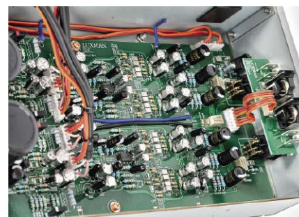
Na płytce analogowej widać oddzielenie torów obydwu kanałów.
